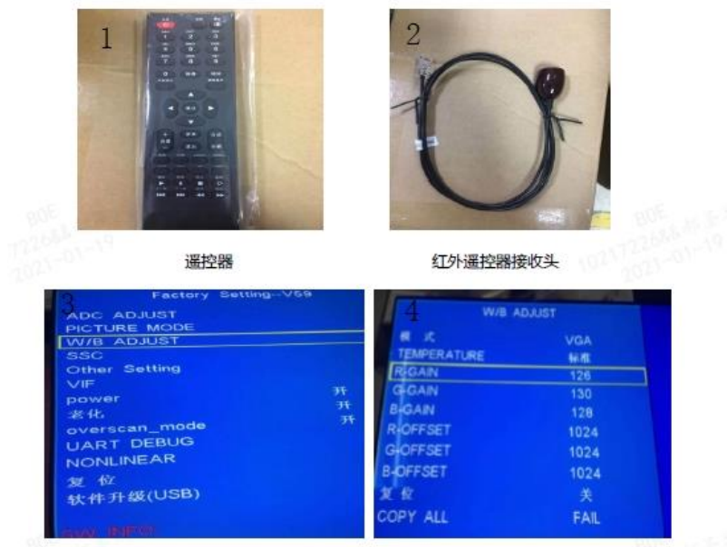
图 9 遥控器调试指导：①遥控器 ②红外接收头 ③工厂模式 ④红蓝增益
