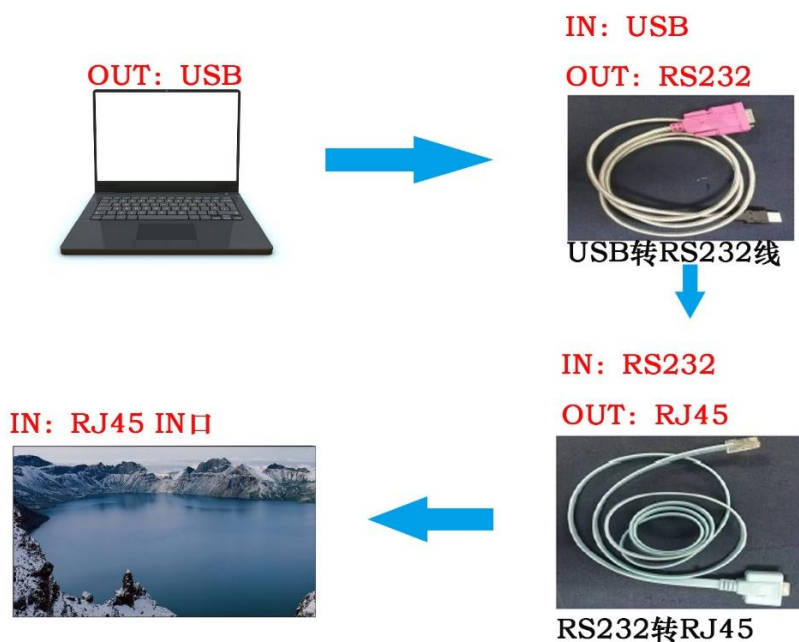
图 10 拼接控制线链接示意图
